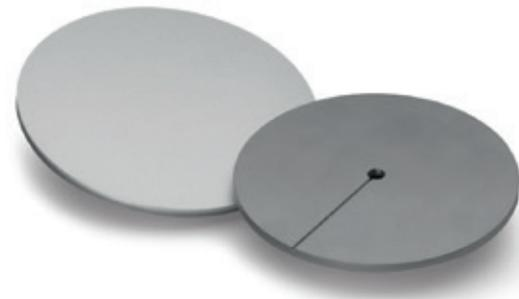
Da sich Molybdän und Wolfram unter Einwirkung von Hitze kaum ausdehnen, sind sie das ideale Material für die Trägerplatten von Hochleistungshalbleitern, die es an den heißesten Stellen auf eine Wärmestromdichte von bis zu 1.000 Watt pro  $\text{cm}^2$  bringen. Zum Vergleich: Eine Herdplatte bringt es im Betrieb gerade auf 8 Watt pro  $\text{cm}^2$ .
