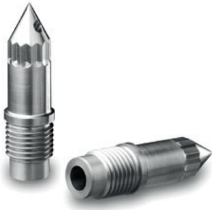
Kunststoffspritzguss ist eine überaus heiße Sache. Durch Düsen wird die Kunststoffmasse unter hohem Druck in eine definierte Form gespritzt. Die Plansee Group fertigt diese korrosions- und verschleißbeständigen sowie formstabilen Heißkanaldüsen aus einer Molybdänlegierung oder aus Hartmetall.
