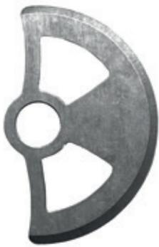
Wolfram-Schwermetalllegierungen sind unmagnetisch, porenfrei und lassen sich gut bearbeiten. Eigenschaften, die wie gemacht sind für die Herstellung von Chronografen, in denen der Werkstoff der Plansee Group als Pendelschwungmasse verwendet wird.
