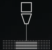
Schicht für Schicht wird das Bauteil produziert
