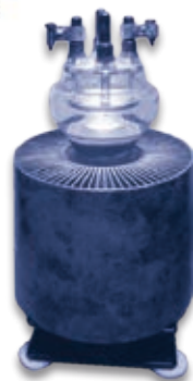
Bis in die 80er-Jahre waren robuste Röhren mit Bauteilen aus Molybdän und Wolfram für die Übertragung im Richtfunk oder von Fernsehsignalen unentbehrlich.
