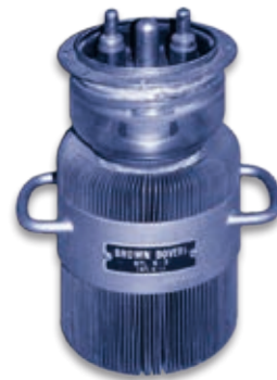
Bis in die 80er-Jahre waren robuste Röhren mit Bauteilen aus Molybdän und Wolfram für die Übertragung im Richtfunk oder von Fernsehsignalen unentbehrlich.
