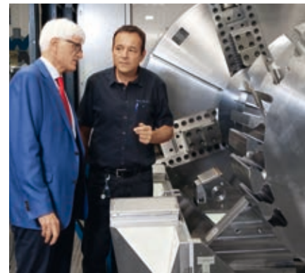
Peter Uttenthaler und Werner Pommer vor dem „Giganten“ unter den Bearbeitungszentren: Er fasst Werkstücke mit bis zu zwei Metern Durchmesser und einem Gewicht bis zu 60 Tonnen.
