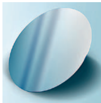
In Schmelztiegeln aus Hochleistungswerkstoffen werden Einkristalle aus Aluminiumoxid erzeugt (Fotos links) und dann zu hauchdünnen Wafern verarbeitet.
