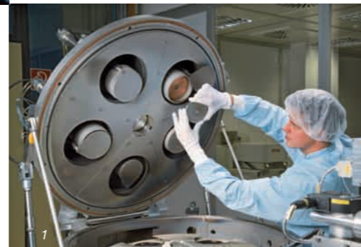
Zu welchen Schichteigenschaften führt der Einsatz verschiedener Beschichtungsmaterialien (1) in der Sputterkammer (2)? Im angeschlossenen Reinraumlabor können die Schichten umgehend analysiert und getestet werden (3).
