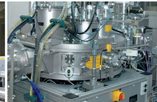
Zu welchen Schichteigenschaften führt der Einsatz verschiedener Beschichtungsmaterialien (1) in der Sputterkammer (2)? Im angeschlossenen Reinraumlabor können die Schichten umgehend analysiert und getestet werden (3).
