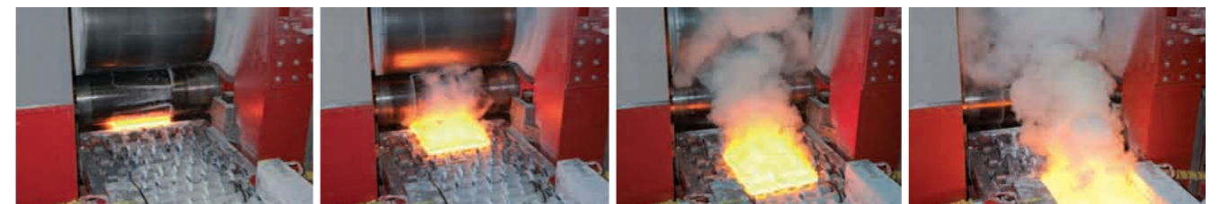
Hochautomatisierter Prozess für das Walzen von Flachprodukten aus hochschmelzenden Metallen: Hier wird ein Sputtertarget aus Molybdän für die Flachbildschirmindustrie gewalzt.
