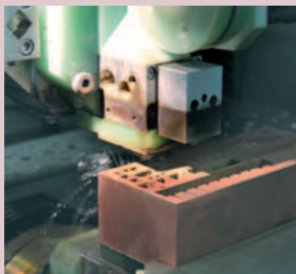
Mittels Drahterosion werden bei Leicht + Müller Stempel und Matrizen aus Hartmetallblöcken von Ceratizit geschnitten.
