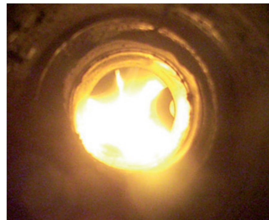
Hält Temperaturen von bis zu 1700 Grad stand: Das Molybdän-Rohr von Plansee zur Müllverschmelzung.
