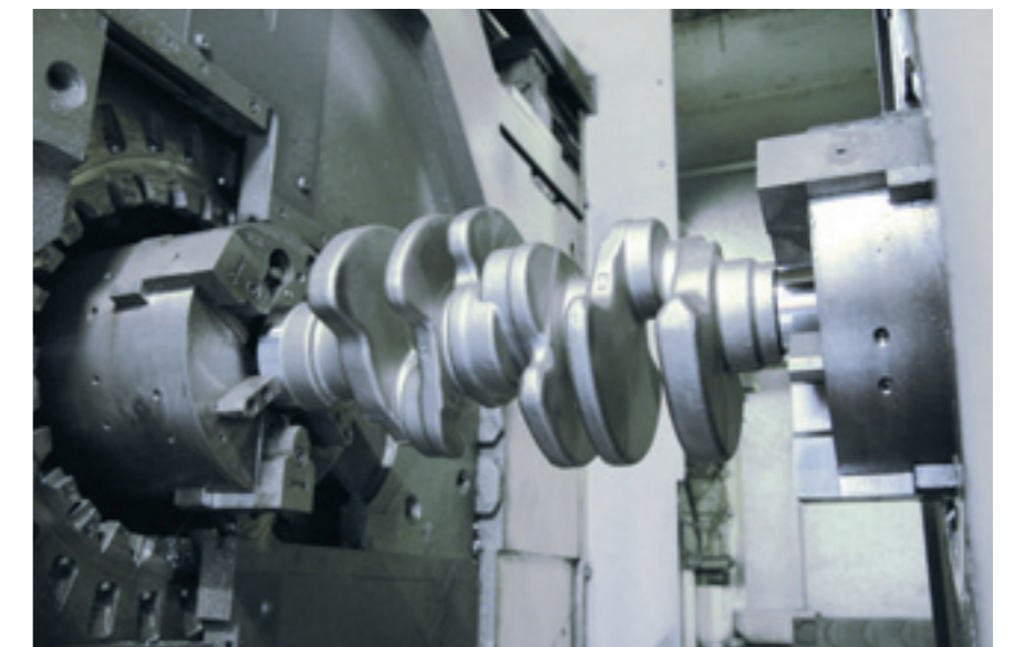
Vor dem Fräsen wiegt eine Kurbelwelle für den 3.0 TDI Motor 26 Kilo, nach der Bearbeitung bringt sie 18 Kilo auf die Waage.
